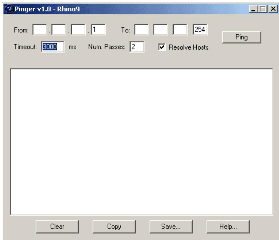
در قسمت From و To مشخص می‌کنیم که از کدام ip تا کدام ip را می‌خواهیم ping کنیم. با فشار دکمه Ping لیست ip هایی که up هستند، نمایش داده می‌شود. فرض کنید که ip فعلی شما 195.219.176.88 باشد و بخواهیم بدانیم در کلاس C مربوط به ما چه ip های دیگری up هستند. در این حالت باید 195.219.176.254 تا 195.219.176.1 را ping کنیم.
